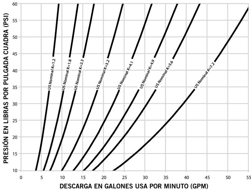
El factor K tiene una tolerancia de +/- 0.2 GPM/ $\sqrt{\text{PSI}}$  (0,2 LPM/ $\sqrt{\text{KPA}}$ ) con el nominal.
